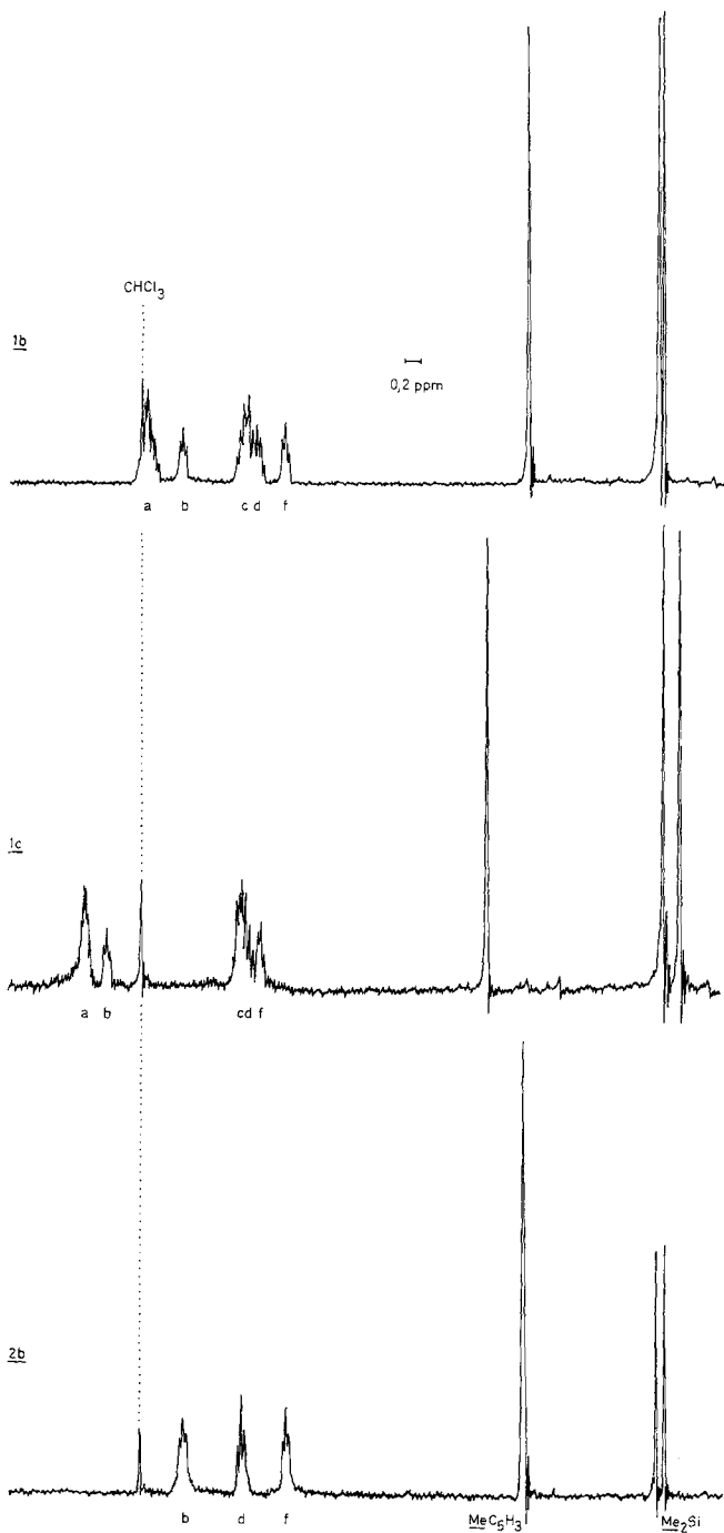
Abb. 2. ^1\text{H-NMR} -Spektren von \text{Me}_2\text{Si}(\text{C}_5\text{H}_4)(\text{MeC}_5\text{H}_3)\text{TiCl}_2 ( 1 b ), \text{Me}_2\text{Si}(\text{C}_5\text{H}_4)(\text{MeC}_5\text{H}_3)\text{TiI}_2 ( 1 c ) und \text{Me}_2\text{Si}(\text{MeC}_5\text{H}_3)_2\text{TiCl}_2 ( 2 b )
